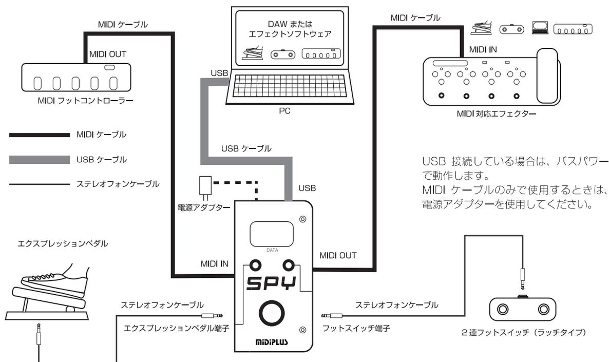
上図の様に接続して使用します。必要に応じて部分的に接続して使用することも可能です（エクスプレッションペダル情報を USB 接続したコンピュータに送るために使用するなど）。また、PC からの MIDI 情報を MIDI-SPY の MIDI OUT 端子から出すこともできますので、音源などを接続して簡易的<sup>(\*)</sup>な MIDI インターフェースとして使用することも可能です。
